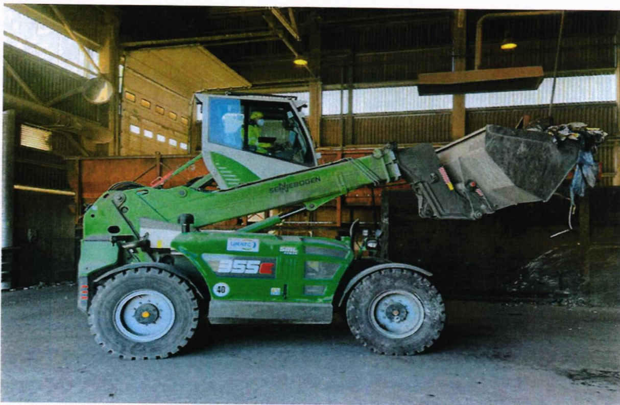
14 pav. Ratinis teleskopinis krautuvus su hidrauliškai pakeliama kabina
